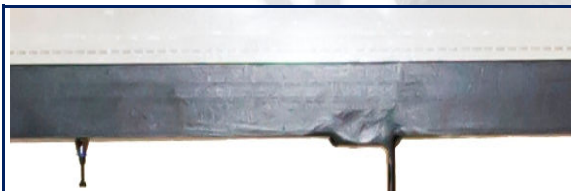
Figura 38. Tomadas de pressão com conectores pneumáticos M5.
