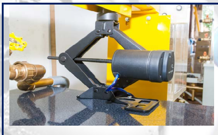
Figura 24. Macaco de parafuso para elevação do canal..
