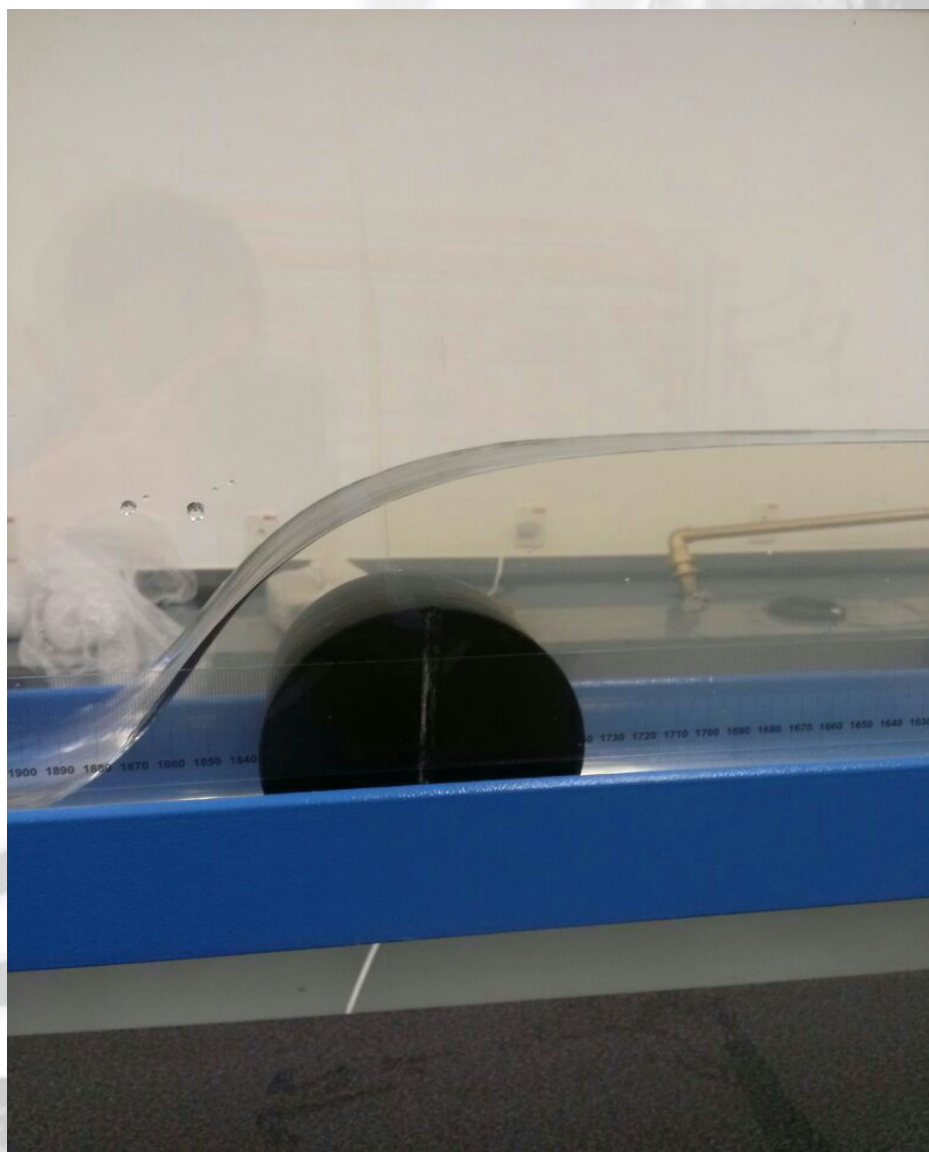
Figura 40. Realizando experimento com ressalto de fundo semi-circular.
