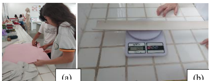
Figura 2: a) Criando o molde para construção das pás. b) Balanceamento das pás.
