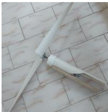
Figura 6: Montagem final do aerogerador.
