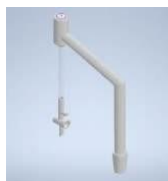
Figura 3. Desenho 3D do doseador do extrator de óleo essencial do tipo Cleavenger.
